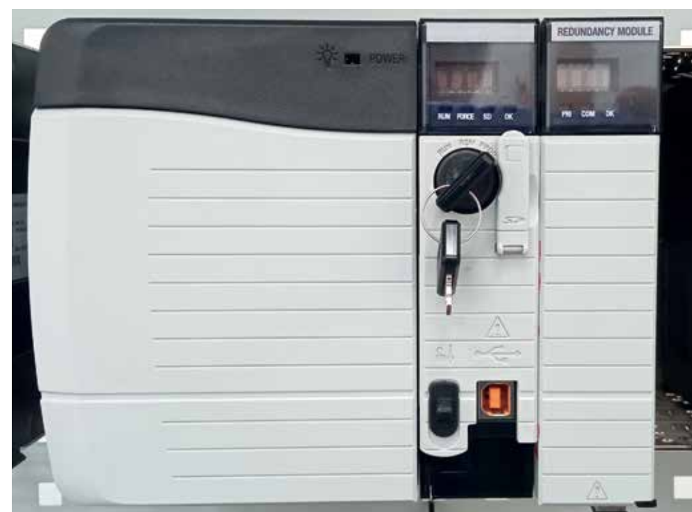
МОДУЛЬ ПЕРЕКЛЮЧЕНИЯ РЕЖИМОВ ПЛК В ИСХОДНОМ ВИДЕ
