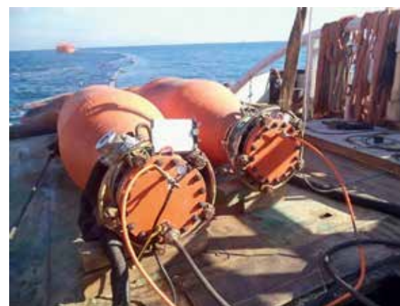
РЕЙЛИНГОВЫЕ ШЛАНГИ ПЛАВУЧИХ РУКАВОВ ВПУ НА БОРТУ ОБСЛУЖИВАЮЩЕГО БУКСИРА
